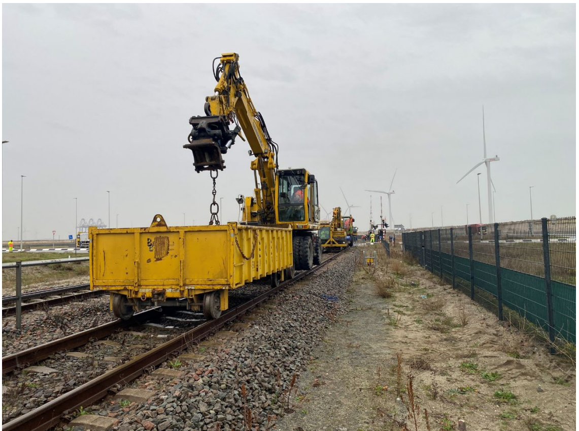
Afbeelding 13: Krol met bak (Berende)
