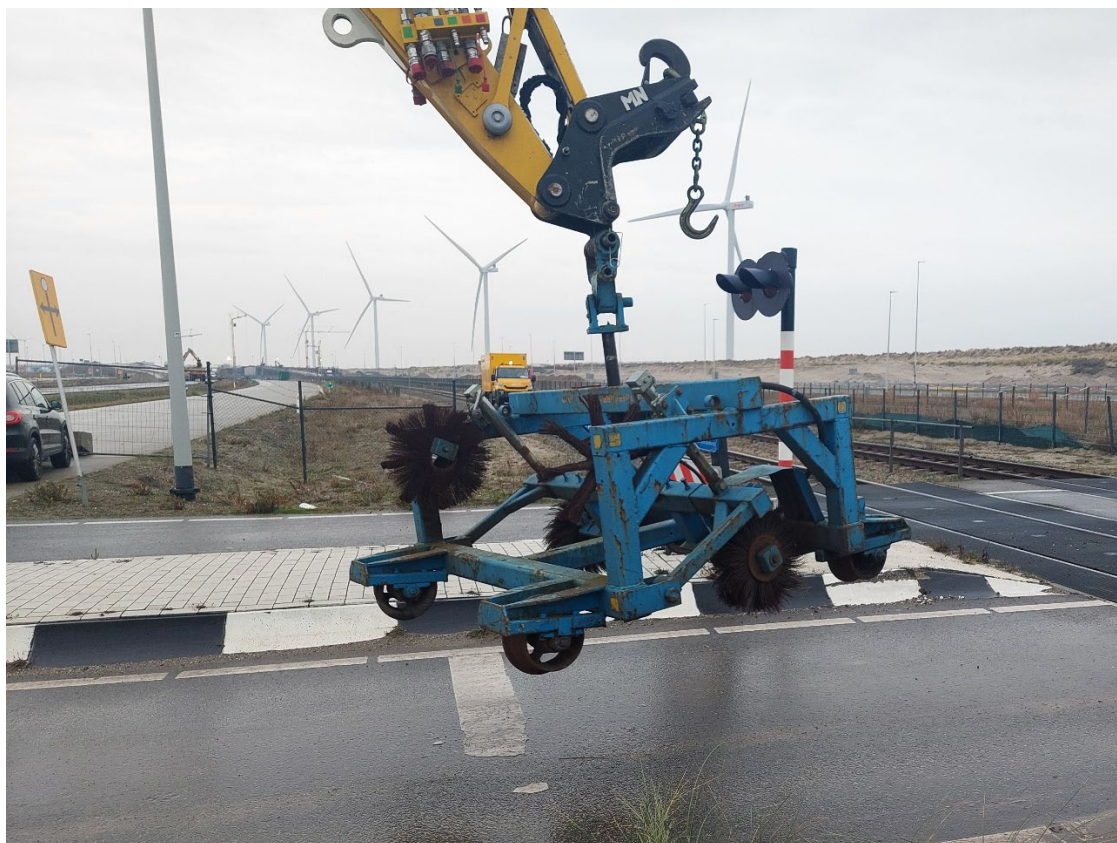
Afbeelding 16: Krol met roestborstel (Berende)
