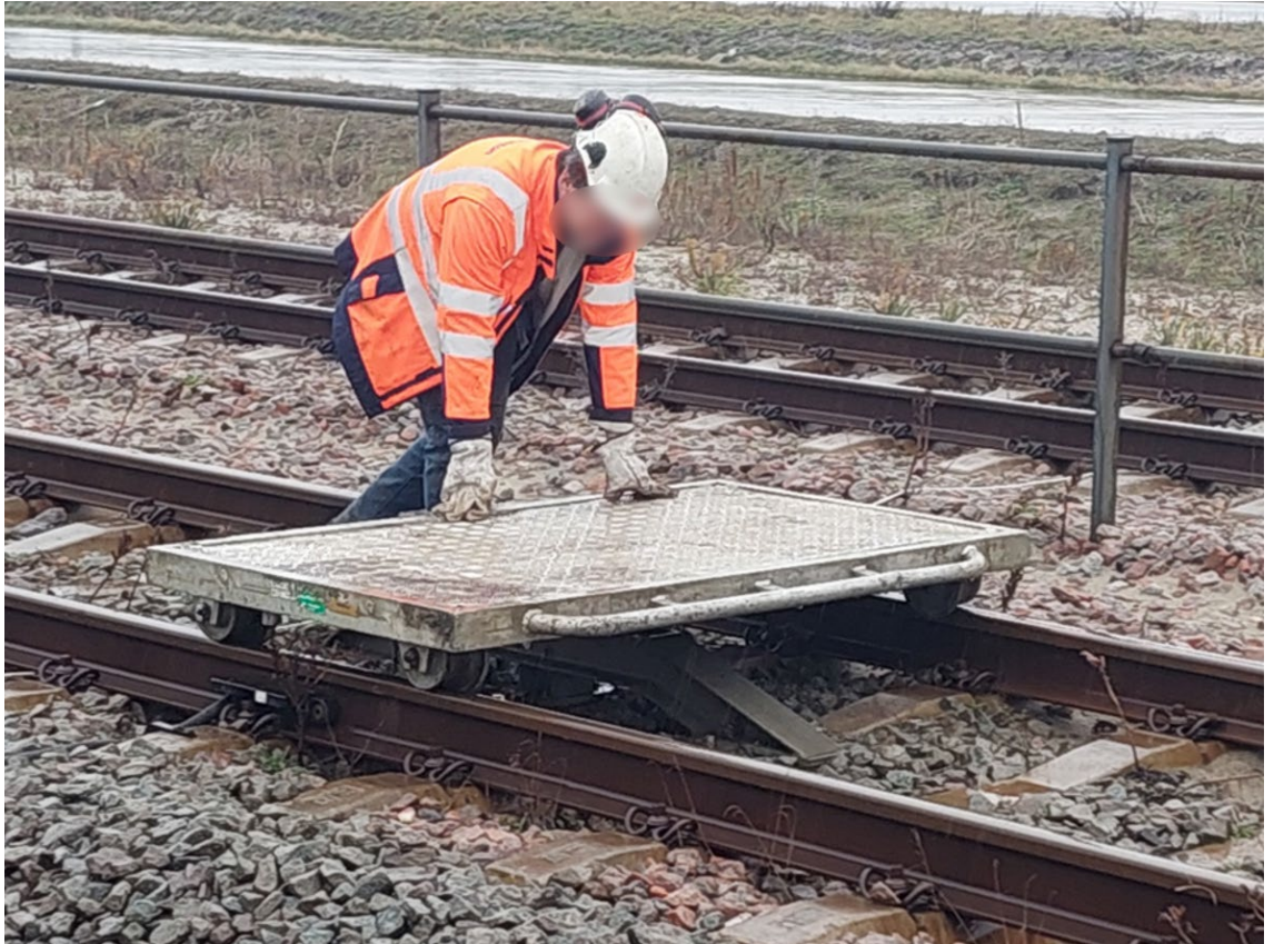
Afbeelding 21: Aluminium duwlorrie (Strukton)
