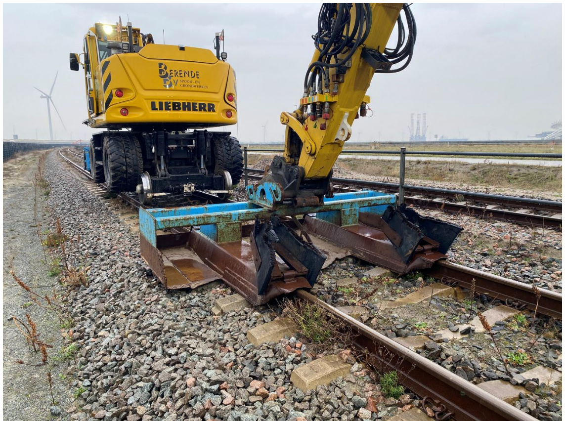
Afbeelding 18: Krol met afwerkbak (Berende)
