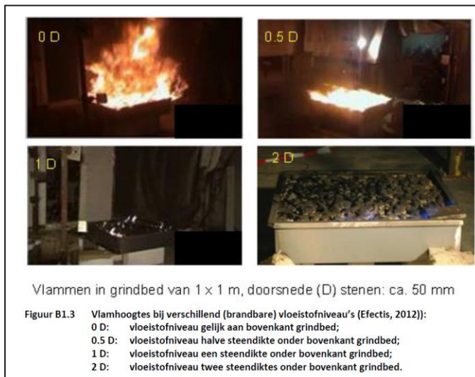
Figuur 17. Vlamhoogtes bij grindbedden met verschillende vloeistofniveaus (Efectis, 2012).
