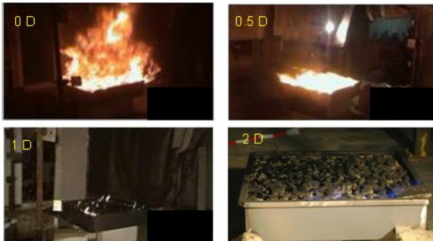
Vlammen in grindbed van 1 x 1 m, doorsnede (D) stenen: ca. 50 mm
