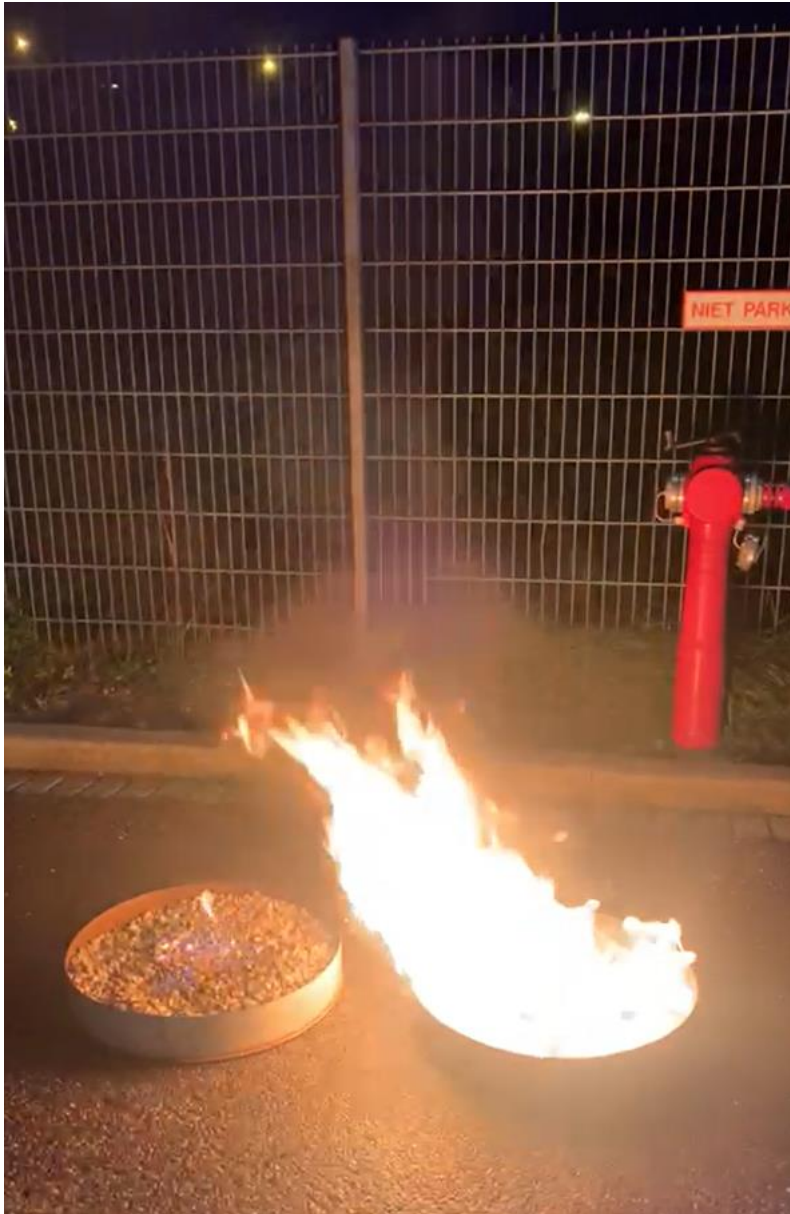
Figuur 13. Vlamhoogtes bij vloeistof in grind/ballast en zonder grind/ballast (praktijkproef GB).
