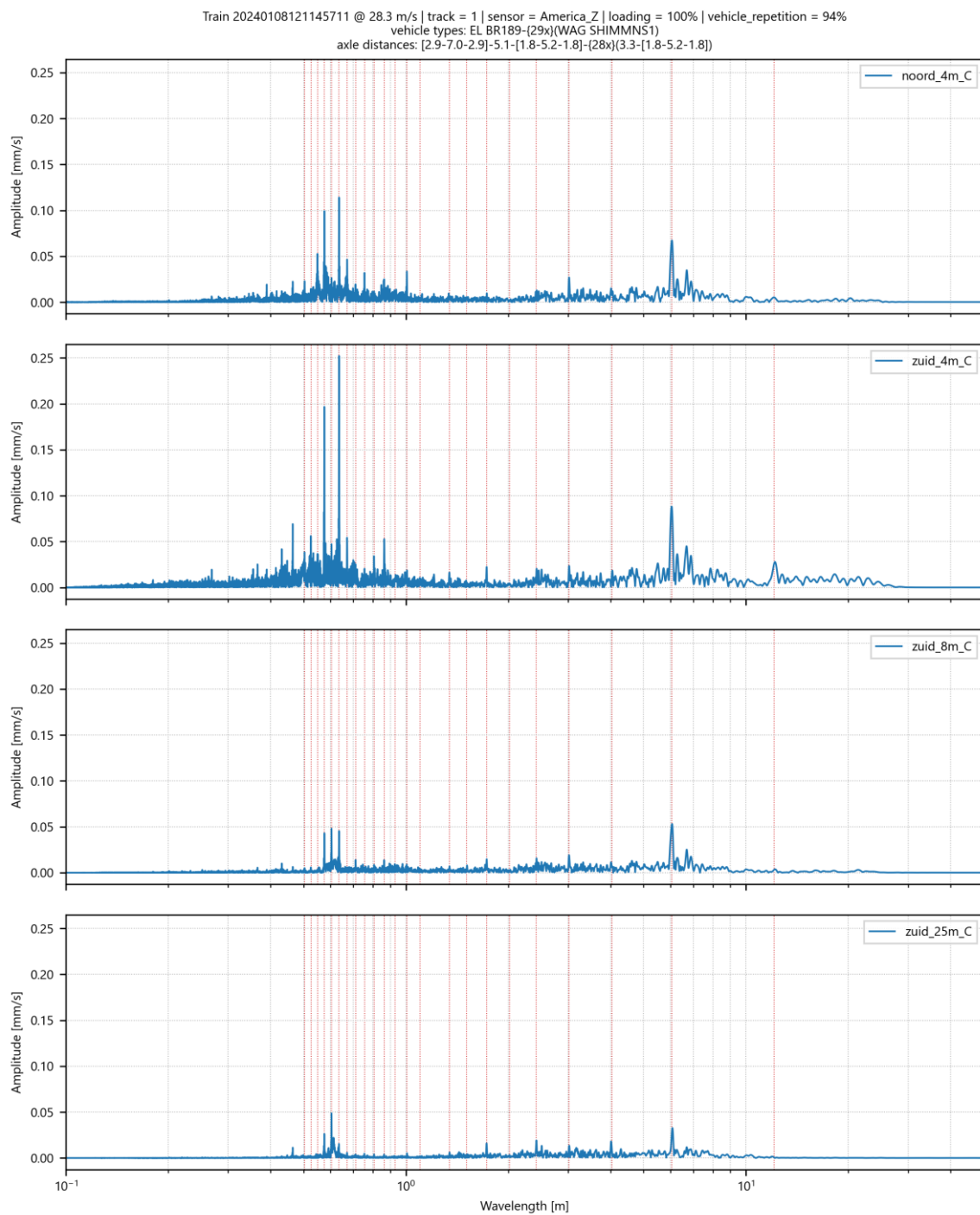
Afbeelding II.29 Amplitude spectrum voor trillingssnelheid in Z-richting op 4 meetpunten in America voor goederentrein passage op spoor 1 op 08-01-2024
