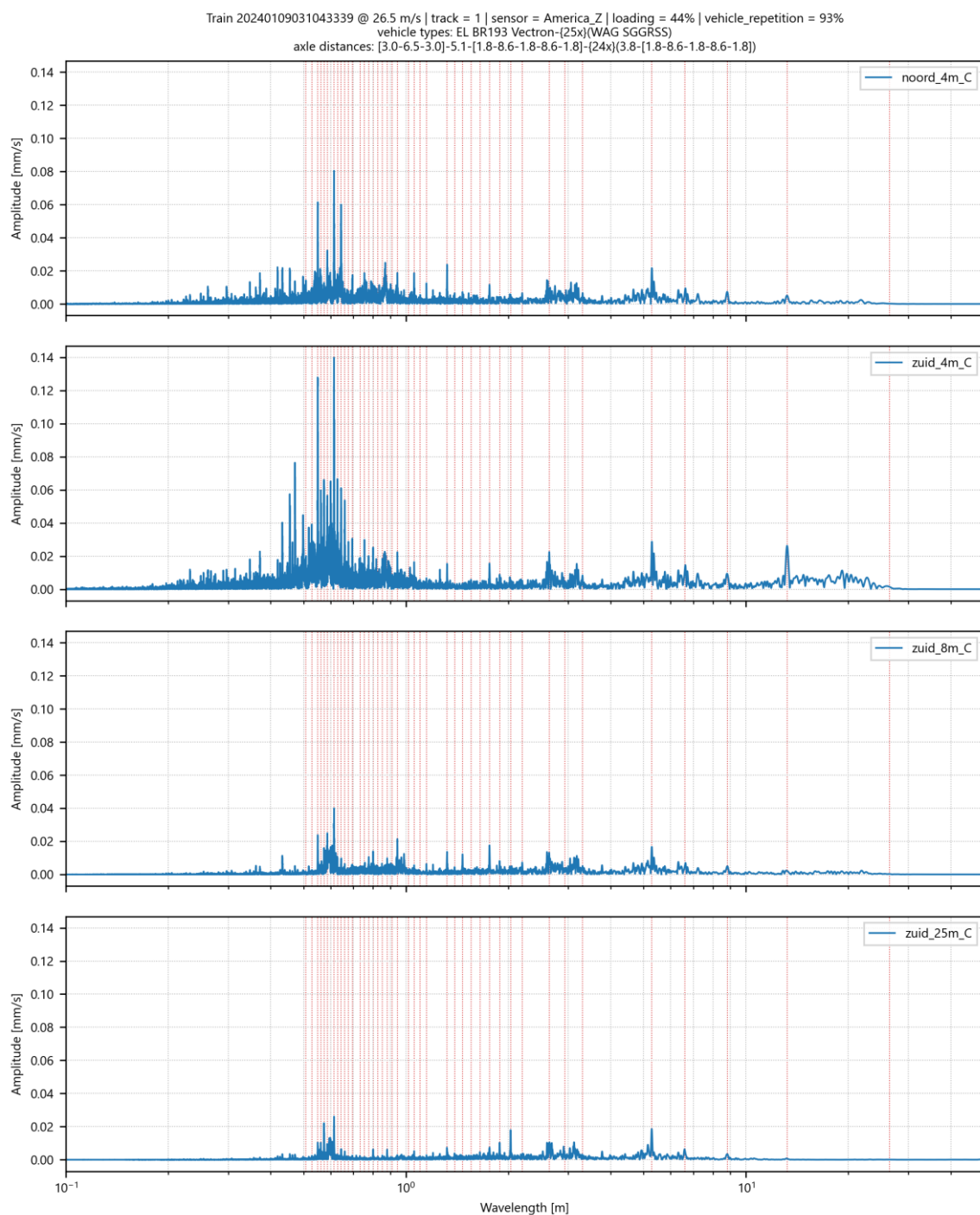
Afbeelding II.38 Amplitude spectrum voor trillingssnelheid in Z-richting op 4 meetpunten in America voor goederentrein passage op spoor 1 op 09-01-2024
