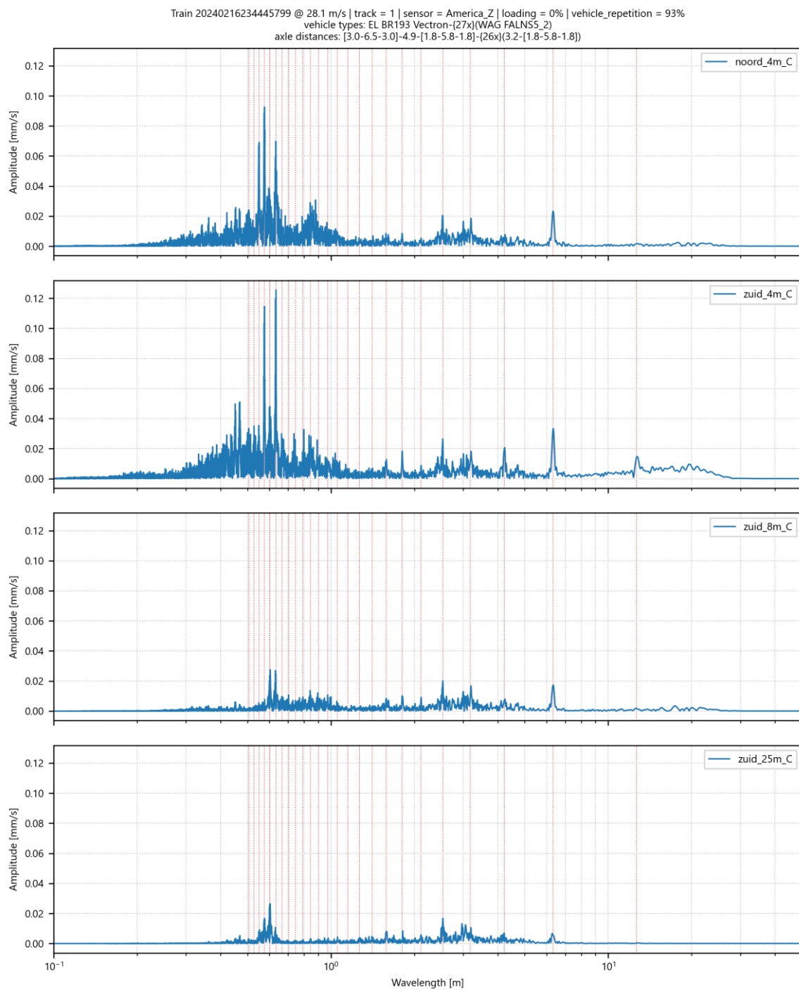
Afbeelding II.23 Amplitude spectrum voor trillingssnelheid in Z-richting op 4 meetpunten in America voor goederentrein passage op spoor 1 op 16-02-2024
