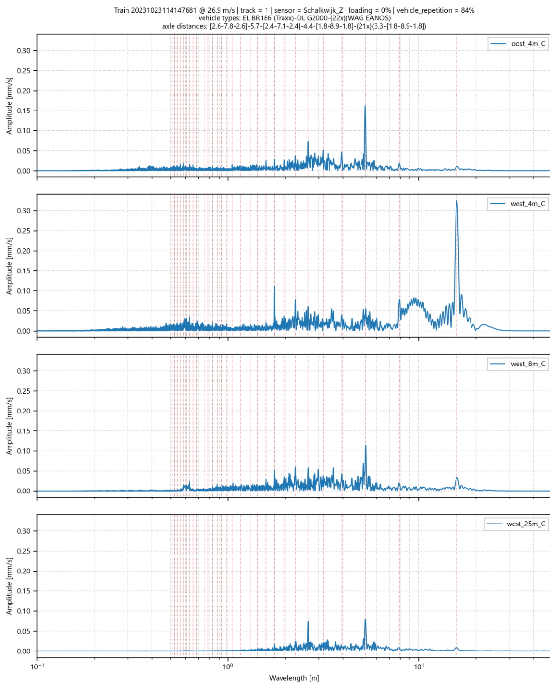
Afbeelding I.26 Amplitude spectrum voor trillingssnelheid in Z-richting op 4 meetpunten in Schalkwijk voor goederentrein passage op spoor 1 op 23-10-2023
