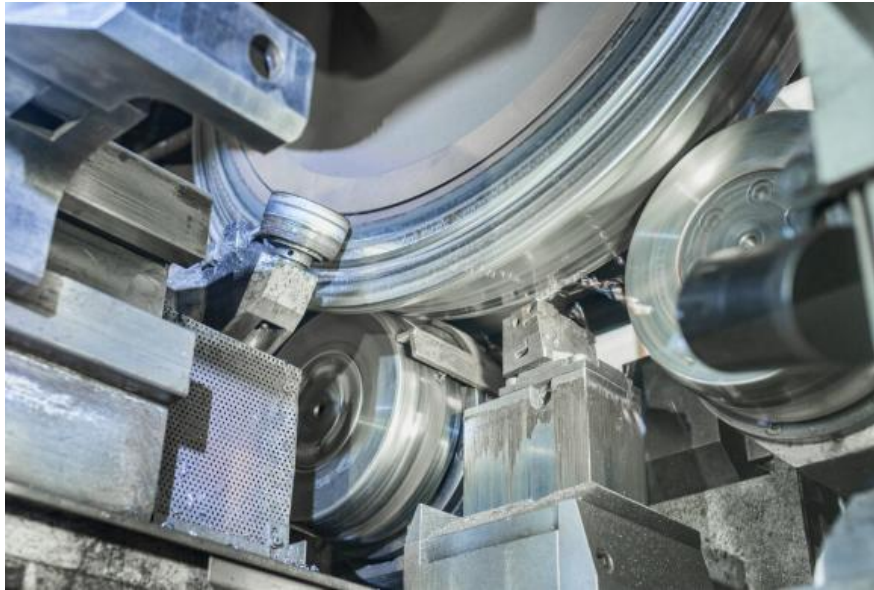
Figuur 10: kuilwielenbank principe [Hegenscheidt]
