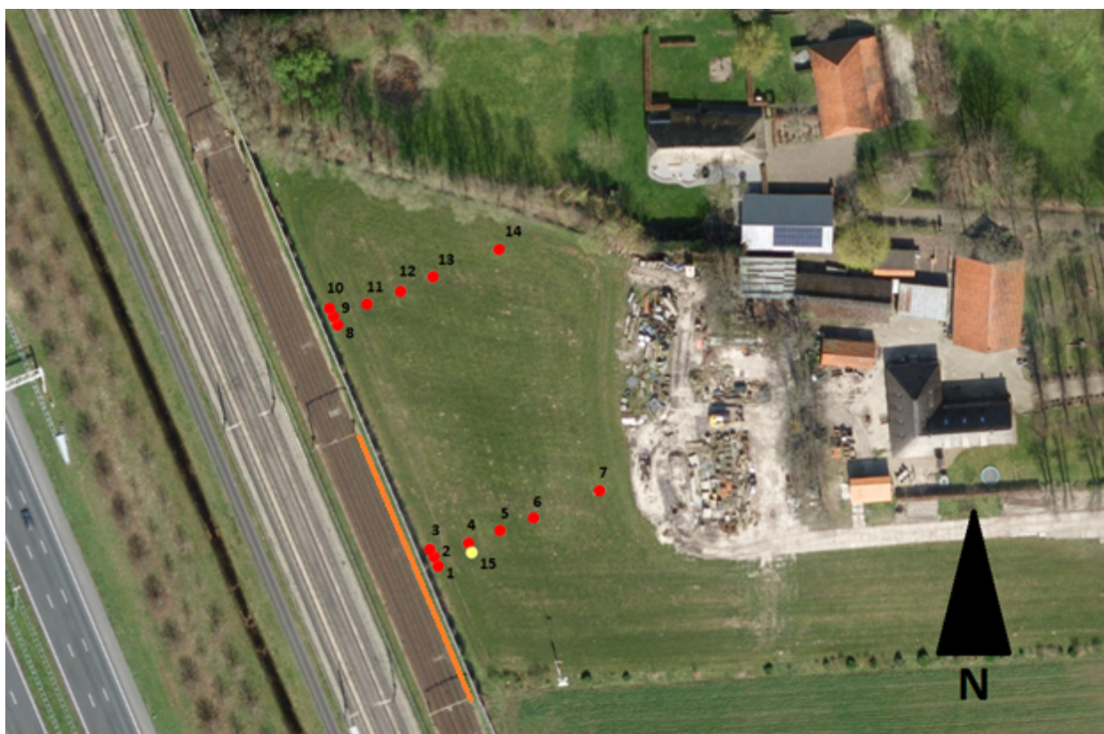
Figuur 3-1 Meetopstelling trillingsmetingen Metabarrier. Sensornummers conform Tabel 3-1. Rode punten geven sensoren korte duurmeting aan; gele punt is sensor langeduurmeting. De oranje lijn geeft de locatie van de maatregel aan.
