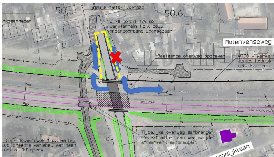
Figuur 4.3 Bouwroute tijdens uitvoering oostelijke toerit. Bouwverkeer moet samen met langzaam verkeer overweg + bestemmingsverkeer Isabellastraat gebruik maken van doorsteek langs toerit.
