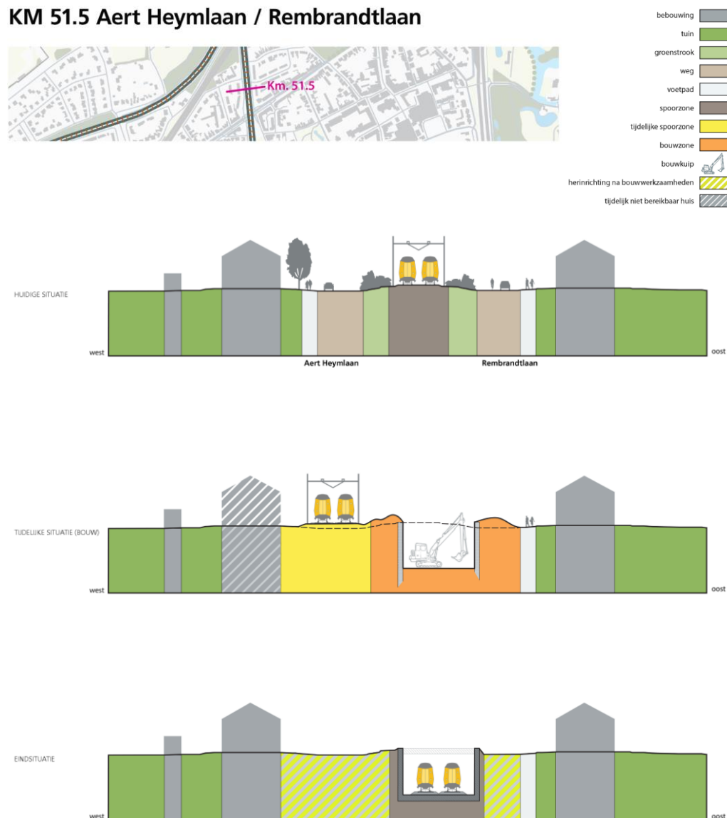
Afbeelding 2.2 Schematische weergave huidige situatie (bovenste doorsnede), bouwsituatie met tijdelijke spoorbaan (middelste doorsnede) en eindsituatie (onderste doorsnede) voor Aert Heymlaan/Rembrandtlaan
