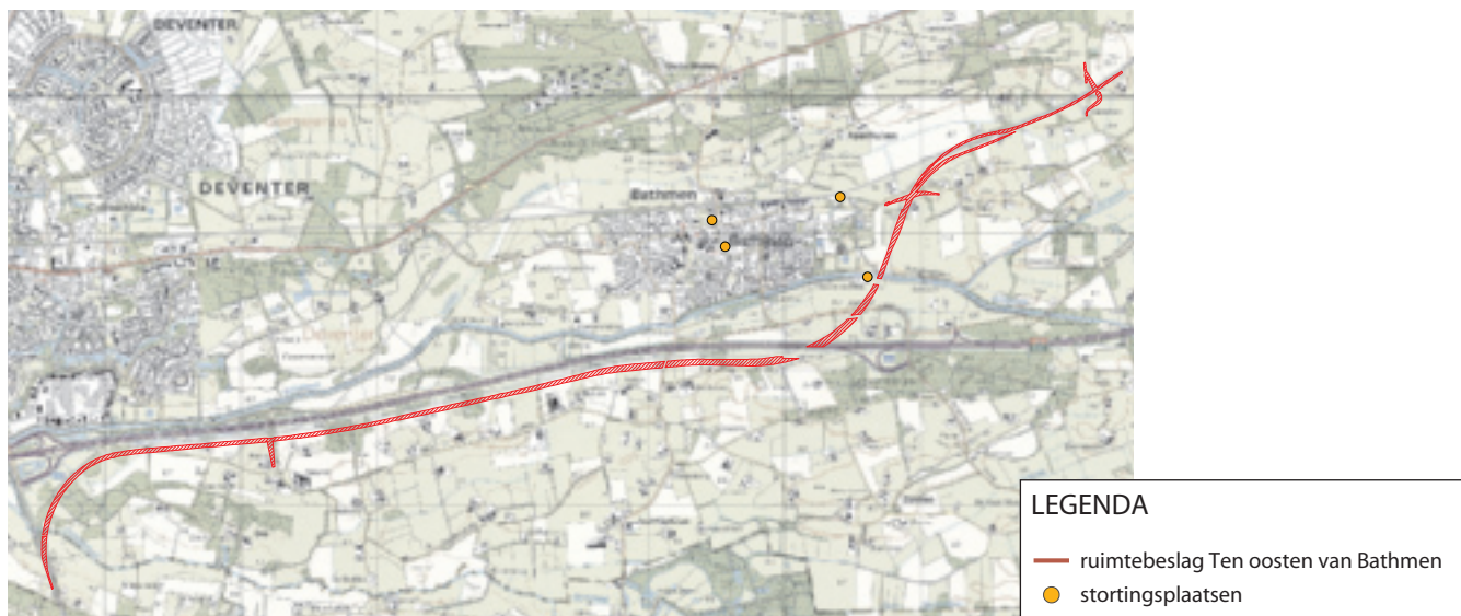
Figuur 6-9 Variant Ten oosten van Bathmen geprojecteerd op bekende asbestonderzoeklocaties en stortlocaties
