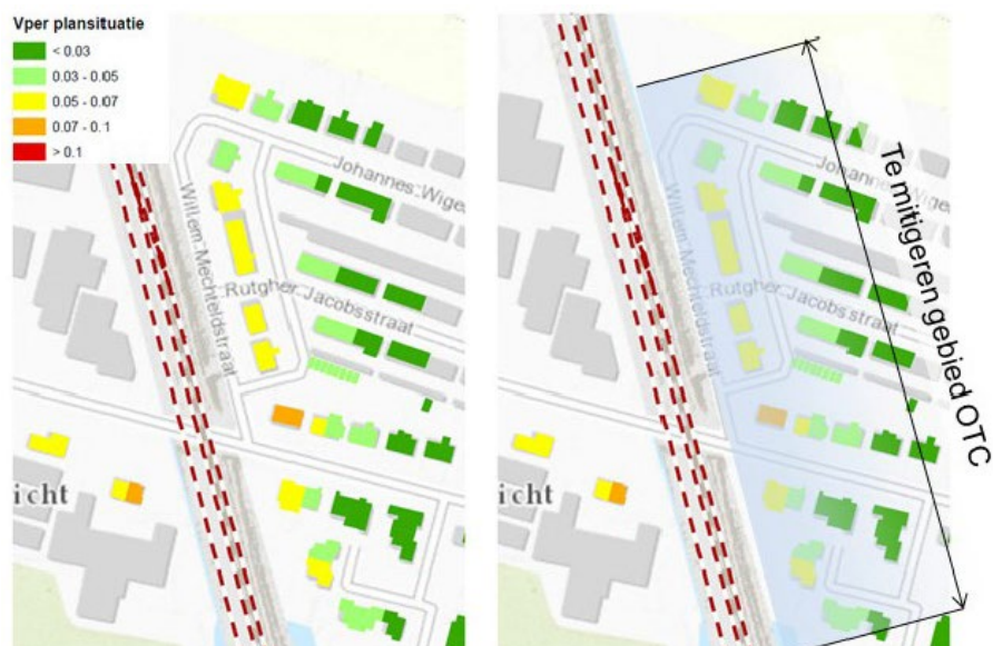
Figuur 4.9 Trillingbelasting v_{per} deelgebied 1.1 en 1.2 (Bron: (Ontwerp) Tracébesluit Spooromgeving Geldermalsen Maatregelrapport trillingsonderzoek, Railinfra Solutions, RIS437-7/pouc/005 definitief 1.0 van 15 november 2016)
