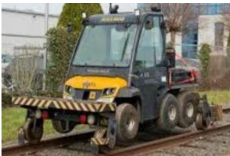
Figuur 5. Een zogenoemde 'Railhog' die is ingezet om roest van de sporen te verwijderen. [Bron: foto van Internet]
