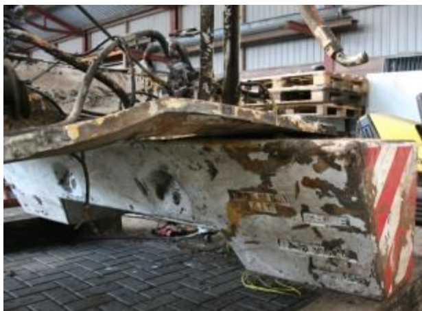
Figuur 9. De rechter crashbuffer raakt onder de motorplaat in de hoek bij het contragewicht.
