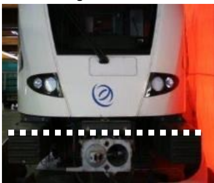
Figuur 6. Eerste contact tussen trein en hoogwerker (in beeld gebracht bij de achterste cabine).
