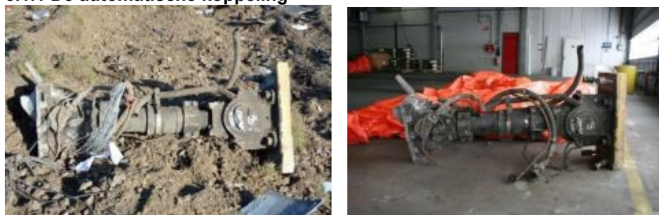
Figuur b14. De automatische koppeling op zijn vindplaats te Dalfsen en na berging te Meppel.
