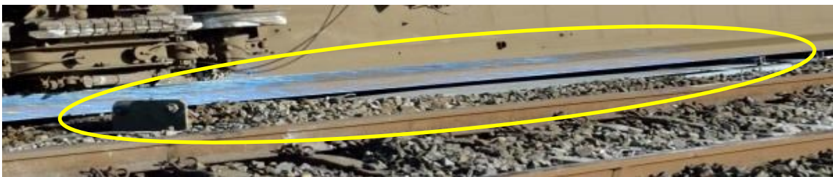
Figuur 13. Bovenleidingmast 16/13 ligt onder de gekantelde wagen B.
