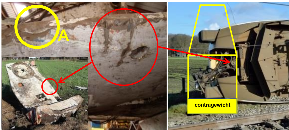
Figuur 8. Reconstructie van de botsing motorplaat met scharnier van de automatische koppeling.
