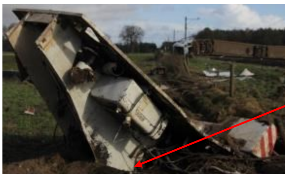
Figuur b9. De 'bok' op de motorplaat bevat een afgebroken deel van de giek met werkbak.
