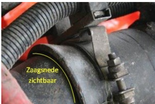
Figuur b16. De automatische koppeling heeft geen grote krachten opgevangen.
