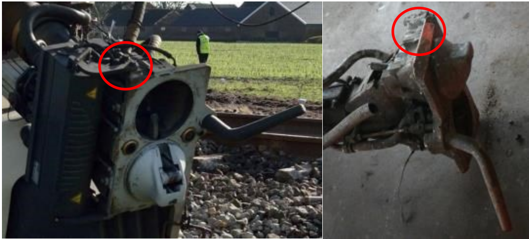
Figuur b15. Bevestigingsbouten van de koppeldoos zijn afgebroken (foto links is de achterste koppeling ter plaatse).
