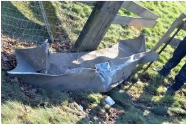
Figuur b20. De baanruimer van wagon A ligt tegen het tuinhok aan de noordzijde van het spoor.
