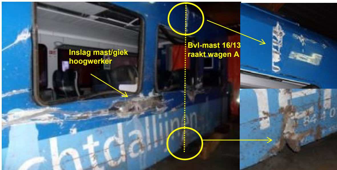
Figuur 11. Inslag bovenleidingmast 16/13 en giek hoogwerker tegen zijwand wagen A.
