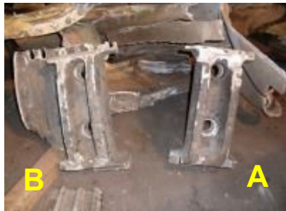
Figuur b18. Twee montagesteunen van de automatische koppeling.
