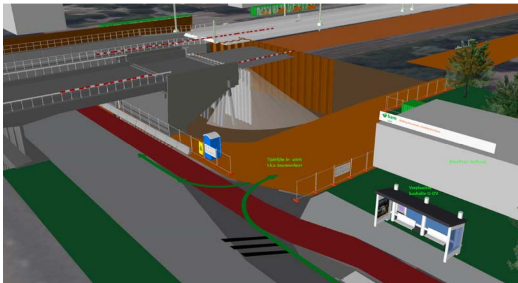
Figuur 2: Overzicht tijdelijke in- en uitrit t.b.v. bouwverkeer aan de noordzijde van het spoorviaduct Cartesiusweg.
